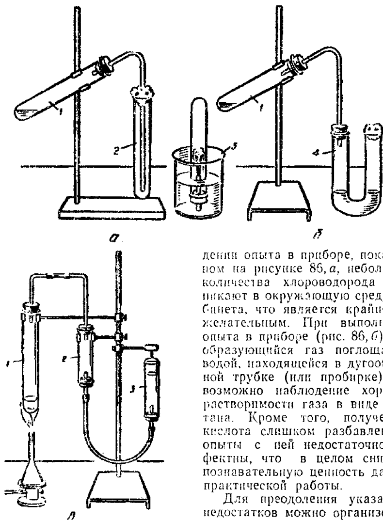
Рис 86. Варианты приборов для получения соляной кислоты и опытов с ней:
